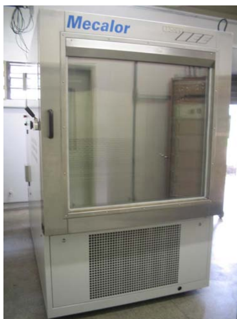
Figura 6.1 – Câmara climática (frontal), IEE/USP (Foto: C. M. Ramos, 2005).
