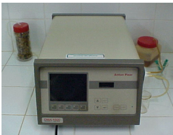
Figura IV.4 – Densímetro automático Anton Paar DMA 4500.
