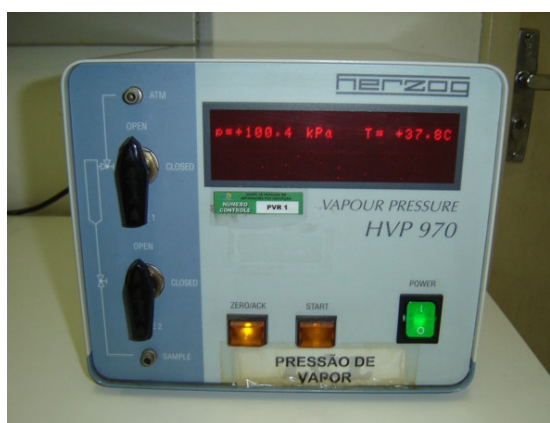
Figura IV.6 – Aparelho para determinação da pressão de vapor Reid.
