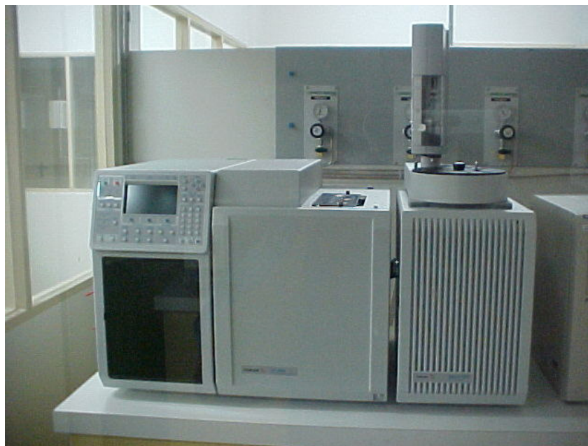
Figura IV.9 – GC-FID-MS utilizado para determinação composicional das gasolinas.
