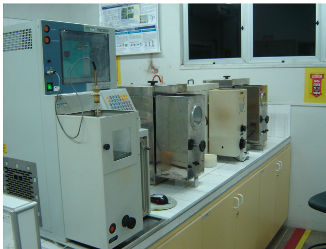
Figura IV.5 – Destiladores de derivados do petróleo utilizados na destilação ASTM.
