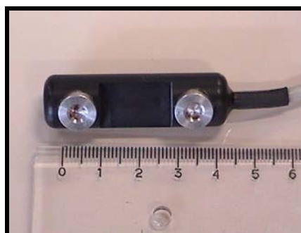
Figura 3. 4 – Foto ilustrativa do eletrodo de estimulação de barra utilizado para estimular o nervo plantar medial (MATTOS, 2003).
