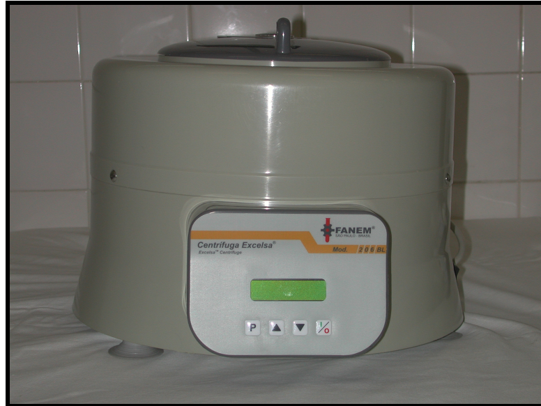
Figura 1 - Centrifuga laboratorial comum Fanem Excelsa Baby® utilizada para obtenção do plasma rico em plaquetas
