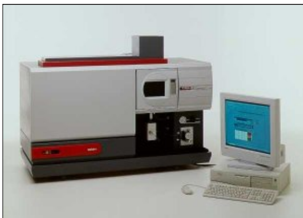
FIGURA 4.1. Espectrômetro simultâneo de emissão óptica com plasma indutivamente acoplado com configuração axial.
