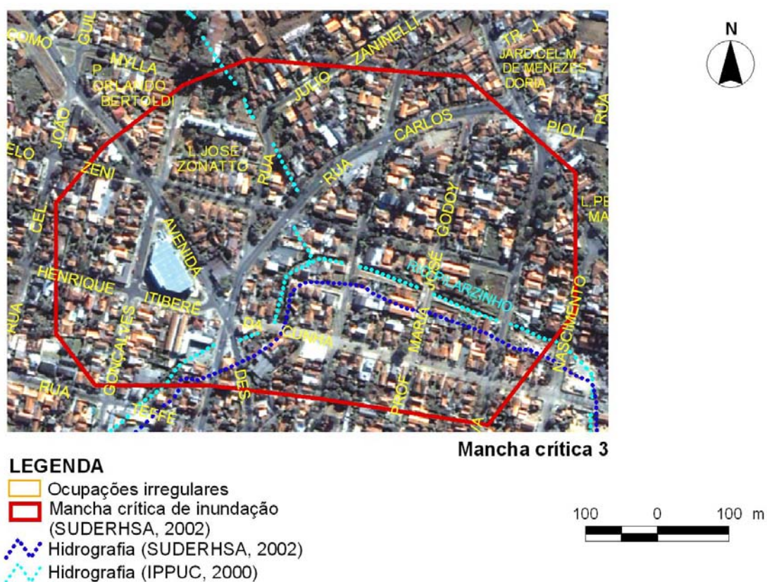
FIGURA 53 – ASPECTOS DA OCUPAÇÃO URBANA - MANCHA CRÍTICA DE INUNDAÇÃO 3 – MÉDIO BELÉM
