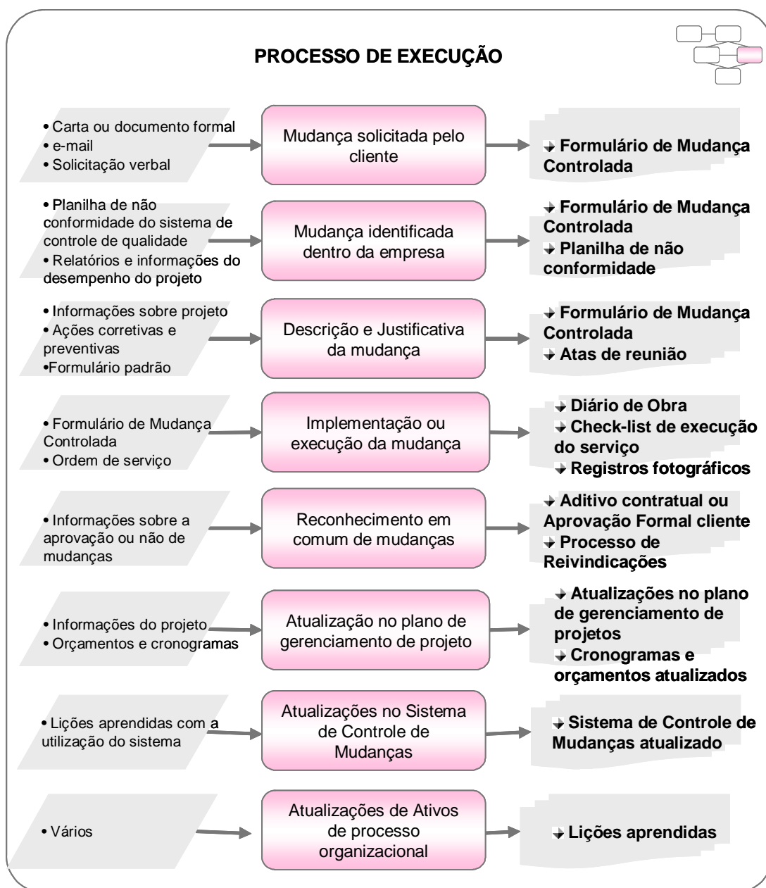
FIGURA 58 – ENTRADAS, AÇÃO E PRODUTO – PROCESSO DE EXECUÇÃO
