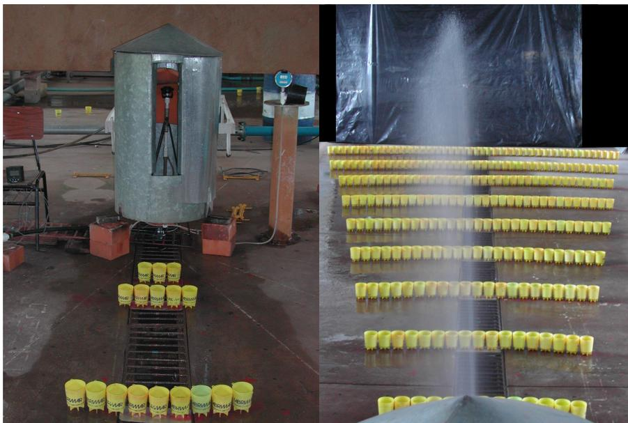
FIGURA 5. Posição do aspersor e dos coletores.
