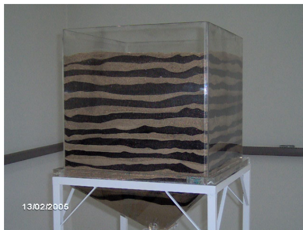
FIGURA 50 - Preenchimento em camadas para análise do fluxo.
