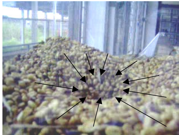
FIGURA 55 - Formação de um funil durante a descarga de café do silo protótipo retangular.
