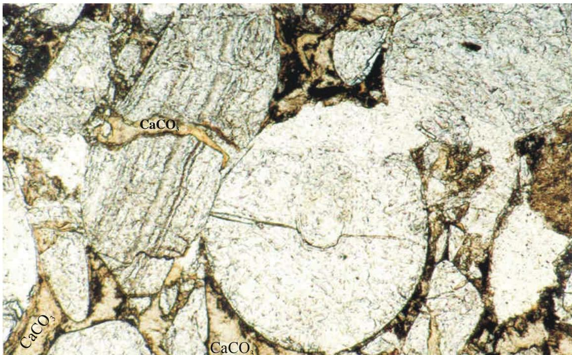
FIGURA 1. *BONE-BED* VISTO AO MICROSCÓPIO, COM AUMENTO DE APROXIMADAMENTE 80 X, COM LUZ POLARIZADA, ONDE PODE-SE OBSERVAR A CIMENTAÇÃO CARBONÁTICA.
