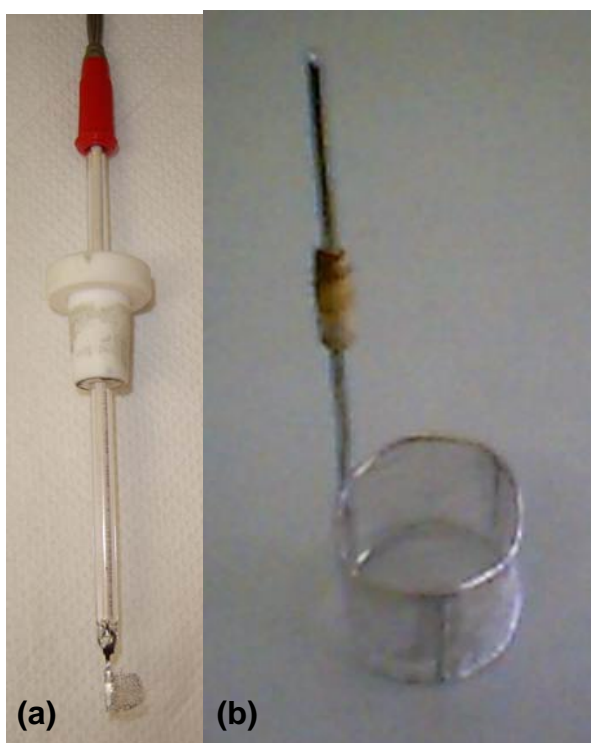
FIGURA 2.5: Eletrodos de platina utilizados como eletrodos auxiliares para deposição dos polímeros (a) e para os testes de Espectroscopia de Impedância Eletroquímica (b).
