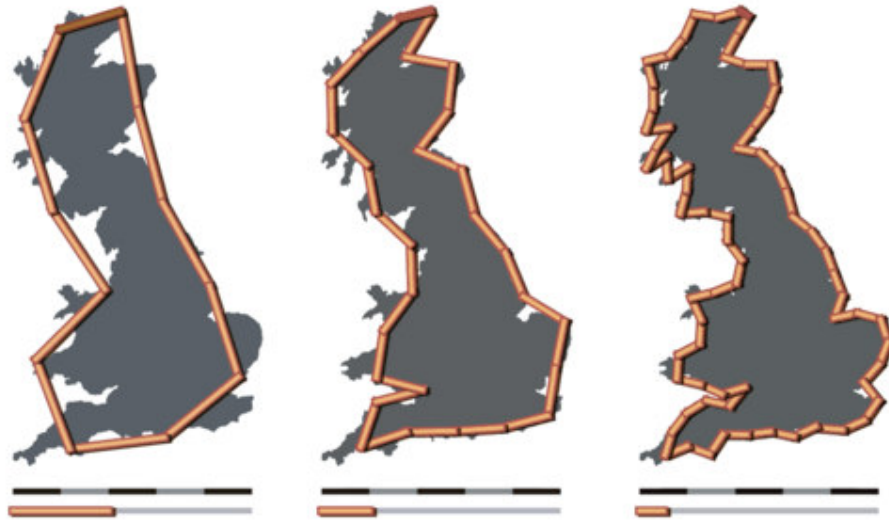
Figura 2.14: Influência da régua na medida do comprimento da linha costeira.
