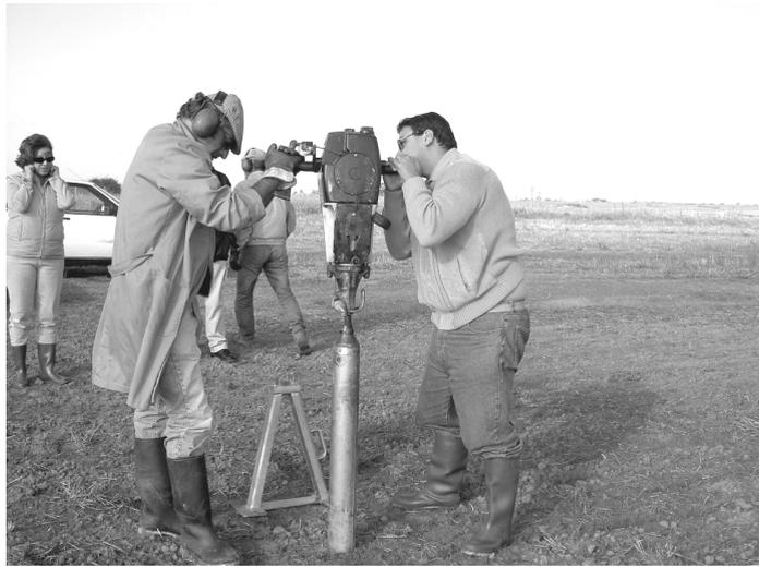
**Figura 27.** Detalhe do amostrador volumétrico pneumático para coleta de amostras de solo+raiz (monolito).
