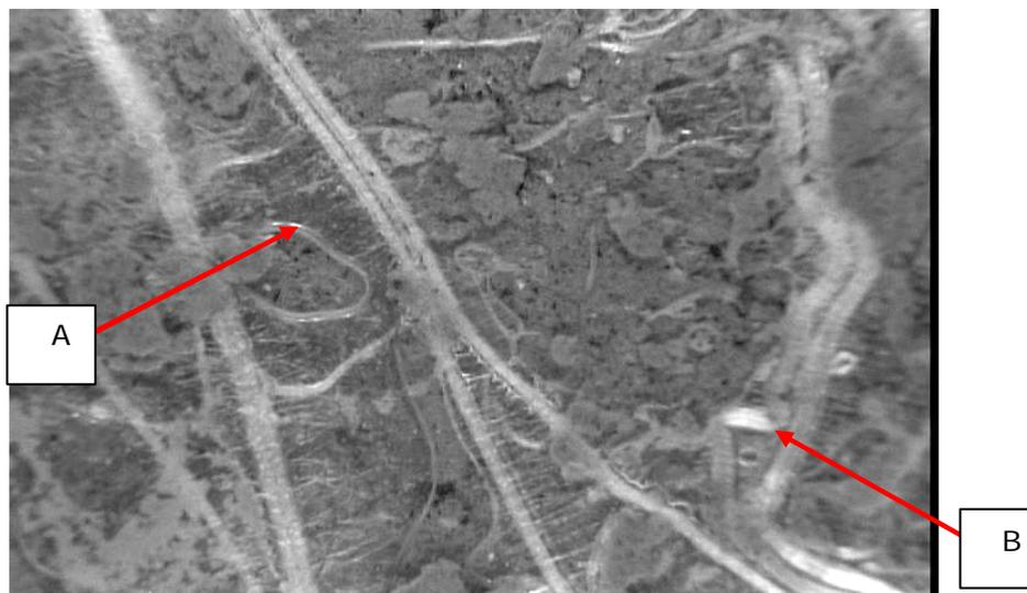
**Figura 33.** A) Raízes com um bom acondicionamento do crescimento na interface solo-tubo. B). Destaque para alterações por efeito de compactação do solo.
