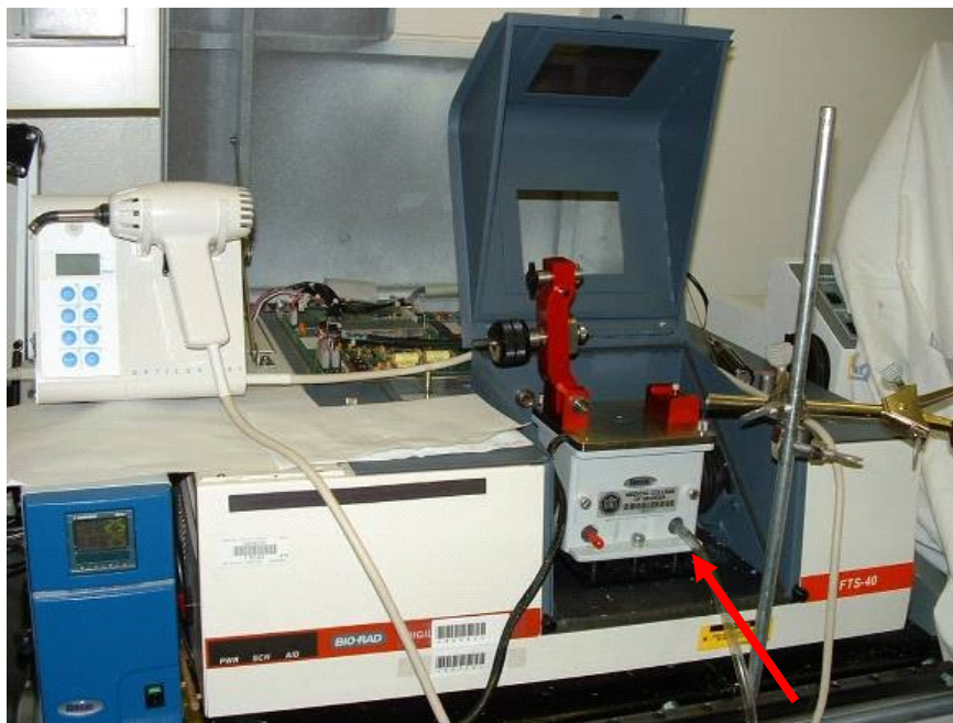
Figura 4.1 – Aparelho de FTIR e a unidade de ATR usados no estudo (seta)
