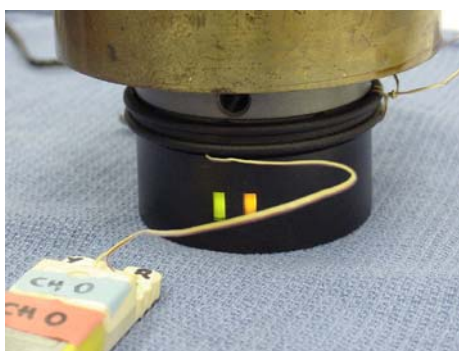
Figura 4.10 – Termopar colocado entre a base e a bandeja do aquecedor de resina
