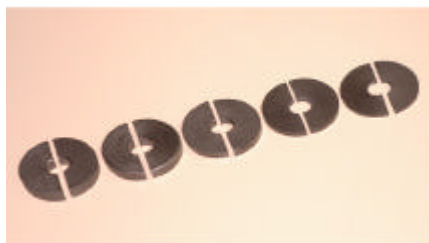
Figura 4.1 – Matrizes de teflon usadas na a confecção das amostras para análise de grau de conversão
