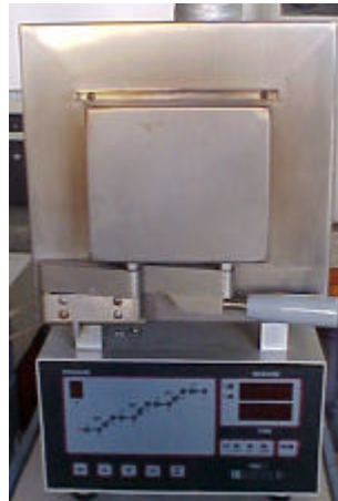
Figura 4.4 – Forno digital utilizado para o tratamento térmico
