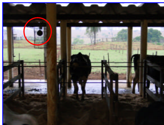
Figura 7 – Posição do data-logger e globo negro dentro do free-stall
