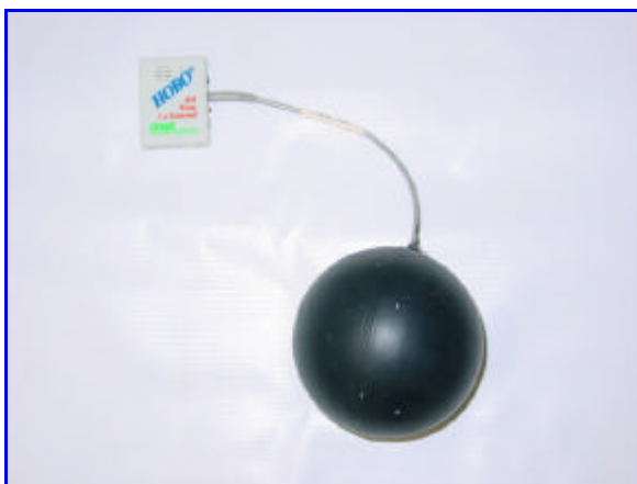
Figura 6 – Data-logger e globo negro utilizados para medidas ambientais
