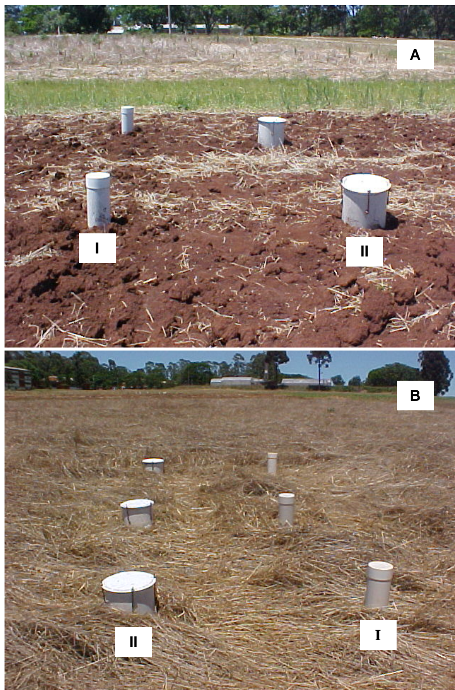
Apêndice 2.2. Comparação das câmaras para medição da evolução de \text{CO}_2 a campo de 15 cm (I) e 30 cm (II) nos sistemas de preparo do solo convencional (A) e plantio direto (B). Cruz Alta, RS.
