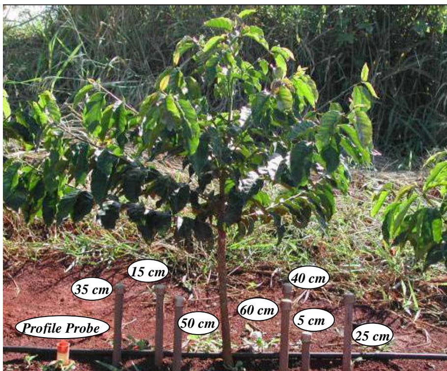
FIGURA 4 Sensores de umidade do solo tipo “Watermark” instalados junto à planta central, a 5, 15, 25, 35, 40, 50 e 60 cm de profundidade, para o controle da irrigação e monitoramento do fluxo de água no solo e haste do Profile Probe. Lavras, MG, 2006.
