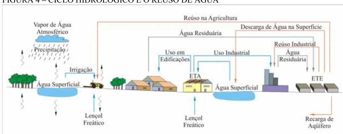
FIGURA 4 – CICLO HIDROLÓGICO E O REÚSO DE ÁGUA
