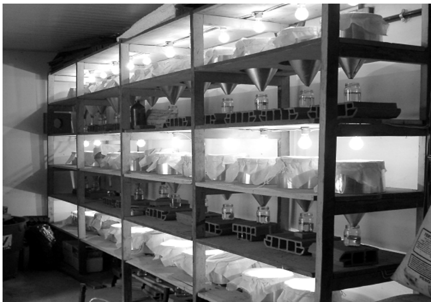
Figura 13. Visão geral de uma bateria de extratores do tipo Berlese-Tullgren.
