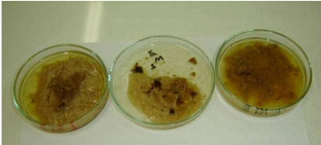
Figura 14 - Aspecto da goma xantana precipitada, sintetizada a partir de X. campestris pv mangiferaeindicae 1230 com soro de queijo mussarela, após 72 horas de fermentação.
