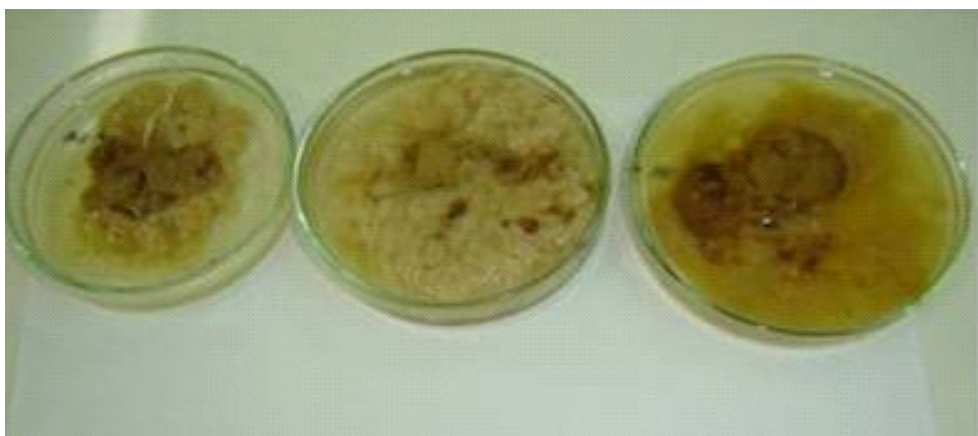
Figura 12 - Aspecto da goma xantana precipitada, sintetizada a partir de X. campestris pv manihotis 1182 com soro de queijo mussarela, após 72 horas de fermentação.
