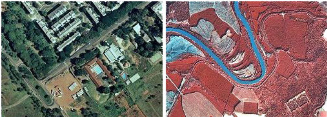
FIGURA 8 - Ortofotos tiradas a partir de sobrevôos. Exemplos de ortofoto em infravermelho e ortofoto colorida 166 . Fonte: < www.esteio.com.br/produtos/paginas/Prod-Orto.htm >.
