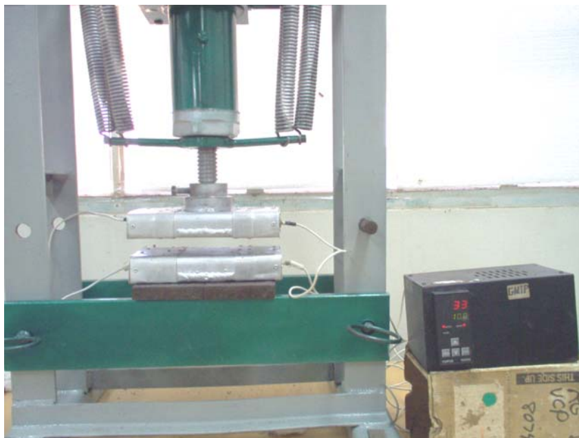
Figura 18: Dispositivo confeccionado para prensagem a morno ( Warm Pressing ). Controle automático (PID)
