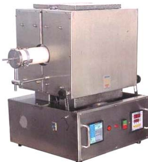
Figura 21: Forno tubular MAITEC FTE-1600/H utilizado para a pirólise das amostras compactadas dos pós do compósito cerâmico.
