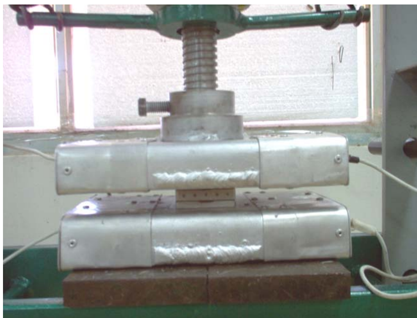
Figura 19: Detalhe do processo de compactação com a matriz.
