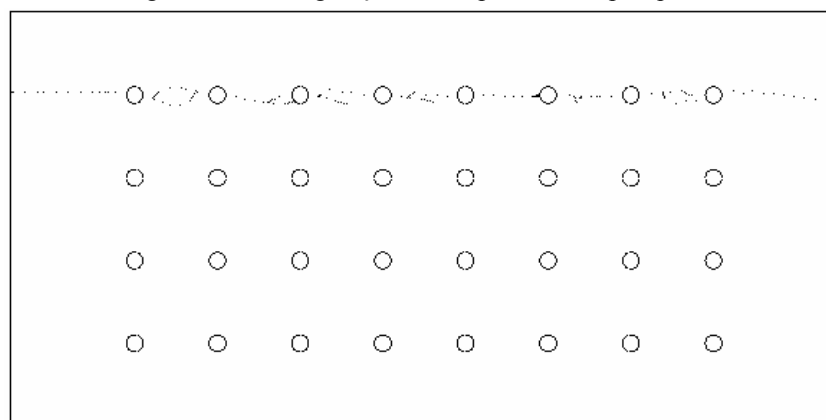
Figura 8.32 Ruptura da estrutura analisada em duas partes.
