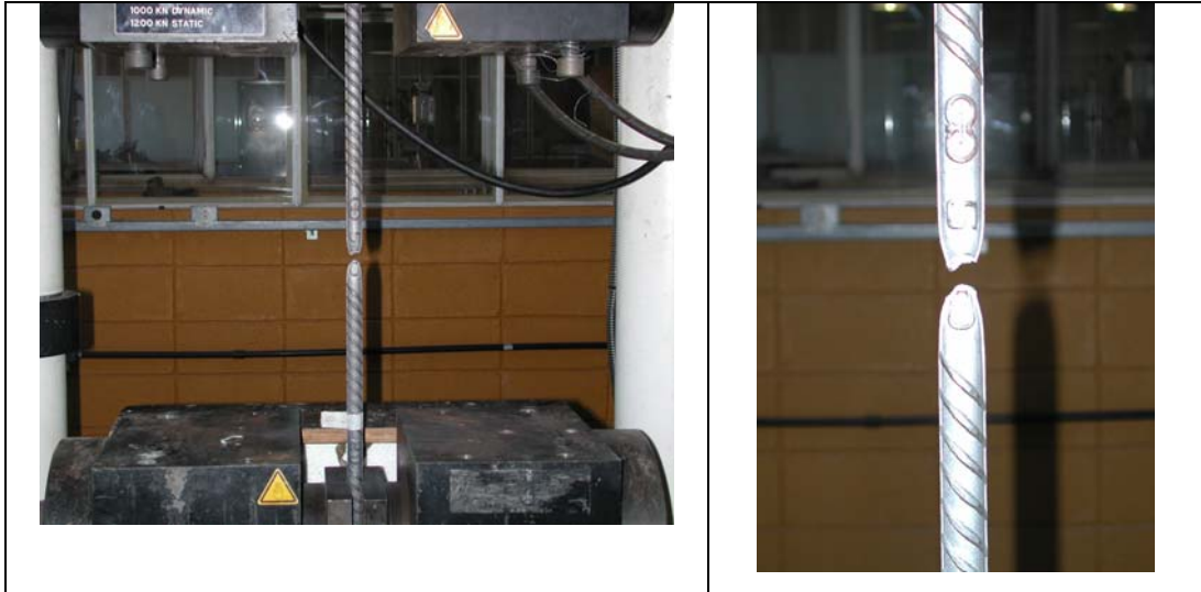
Figura 5.4 Exemplo de ruptura típica de ensaio de tração de barras de aço
