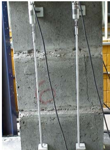
Figura 3.30 – Ensaio prismas de três blocos de concreto
