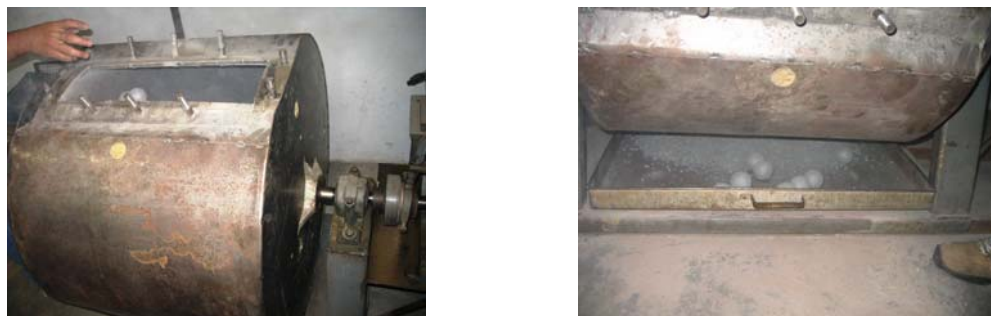
Figura 3.9 – Ensaio de abrasão na máquina “Los Angeles”
