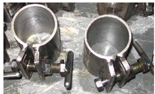
d) Fôrma adaptada para desmoldagem imediata
