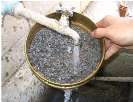
c) Limpeza do agregado com água
