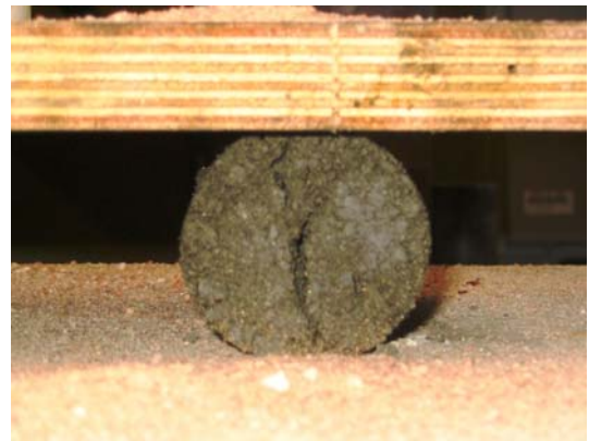
b) Detalhe de ruptura
