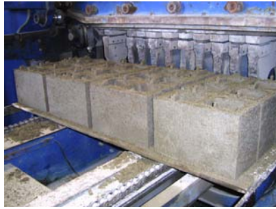
a) Moldagem do bloco
