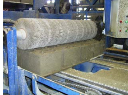
b) Limpeza de imperfeições no bloco
