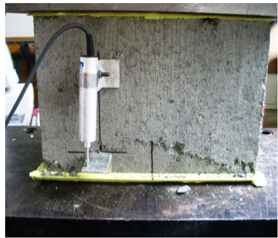
b) Fissura despreendendo a cantoneira
