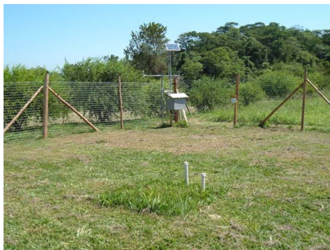
Figura 16 – Estação meteorológica na área do lisímetro.
