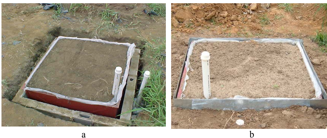
Figura 14 – Vista do lisímetro totalmente preenchido com solo (a) e detalhe das chapas laterais utilizadas como acabamento (b).
