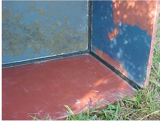
Figura 11 – Detalhe da vedação realizada na caixa lisimétrica.
