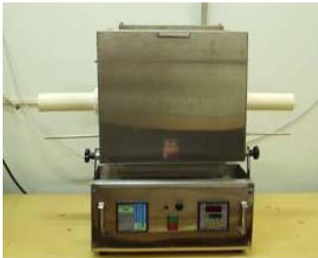
Figura 3.2 - Forno utilizado na sinterização das amostras.
