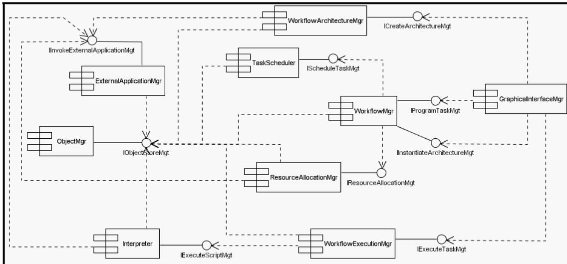
**Figura 46** – Diagrama de componentes para WfMS.
