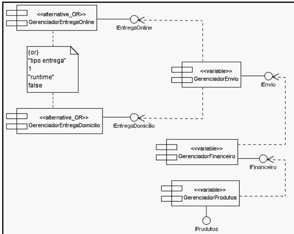
**Figura 34** - Representação de multiplicidade e tempo de resolução de pontos de variação em diagrama de componentes de um processo de compra via Internet.
