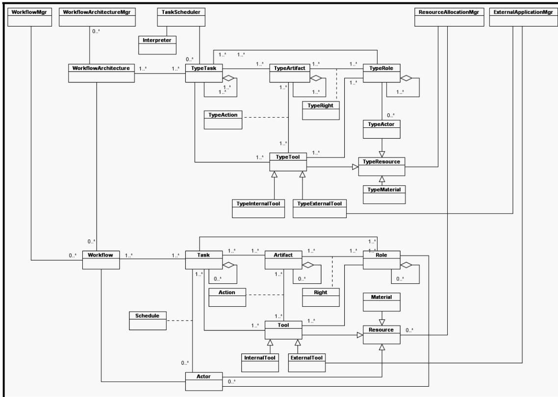
Figura 44 – Modelo estático de tipos para WfMS.
