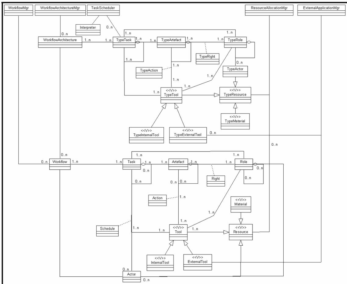
**Figura 17 - Diagrama estático de tipos para WfMS**
