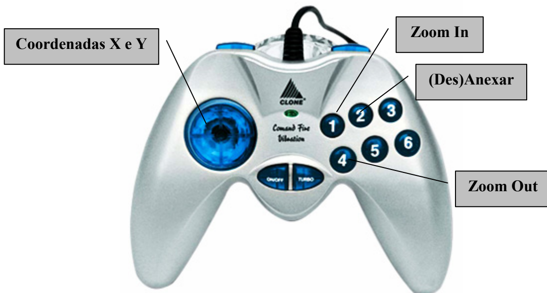
Figura 47 - Forma de usar o Joystick no IMSM.
