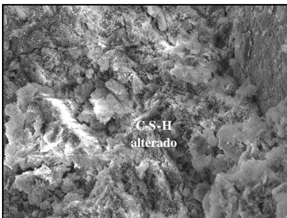
Figura 5.46 - Concreto de alta resistência à 900°C (x1000)
