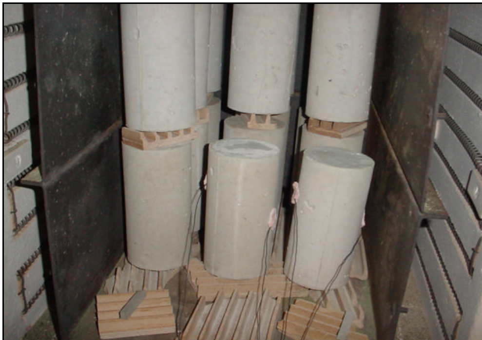
Figura 4.17 – Sistema de monitoramento da temperatura
