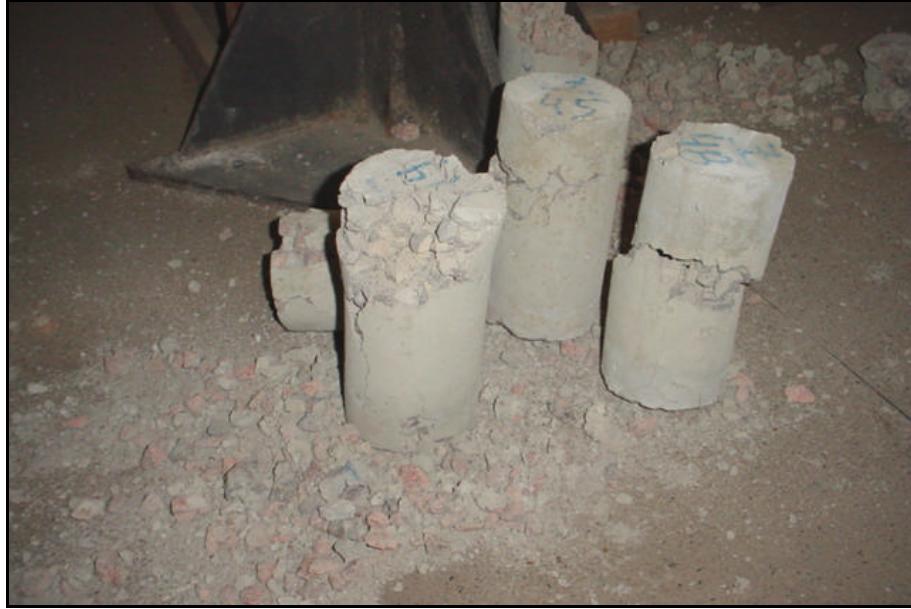
Figura 5.9 – Desagregação dos concretos com baixa compactidade à 900°C durante o transporte
