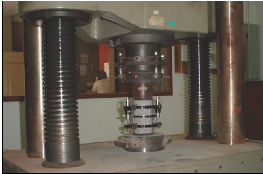
Figura 4.11 – Ensaio para determinar o módulo de deformação.
