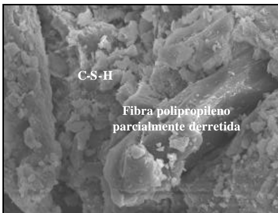
Figura 5.58 - Concreto de alta resistência com 10% sílica-ativa à 200°C (x1100)
