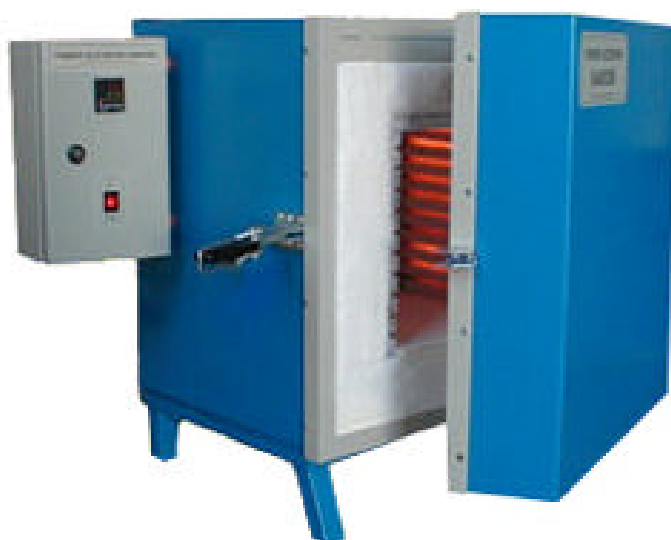
Figura 4.9 – Forno elétrico empregado para o aquecimento das amostras
