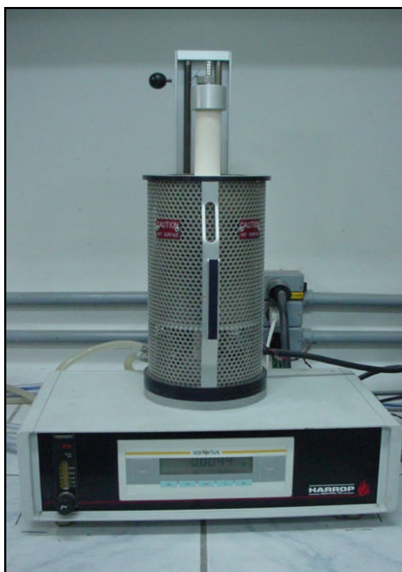
Figura 4.16 – Equipamento utilizado no ensaio de análise termo-diferencial
