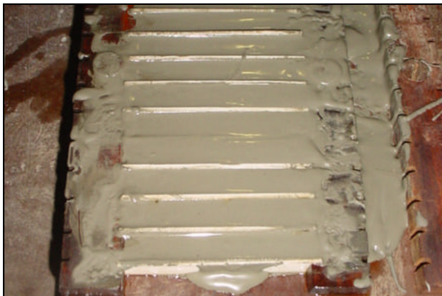
Figura 4.8 – Processo de moldagem dos cps prismáticos de argamassas e pasta
