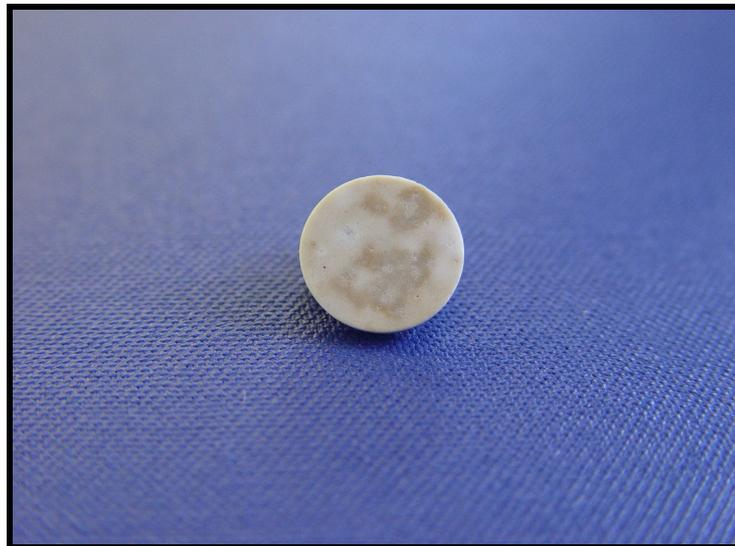
FIGURA 4 – Amostra da biocerâmica Pseudowolastonita em disco
