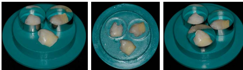
Figura 15 – Metades estabilizadas na base do dispositivo para embebição de amostras e isoladas uma das outra pelo uso do anel metálico.
