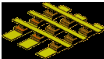
Fig. 1.7. Um arranjo de um chip de leitura/escrita MRAM [5].
