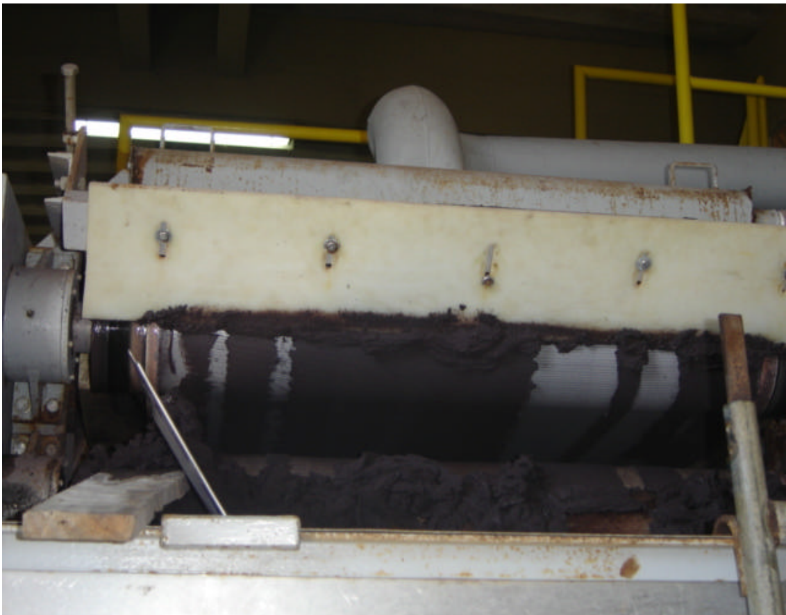
IMAGEM 05: Foto de uma maquina de prensagem do lodo da Indústria Têxtil Blumenau S.A.
