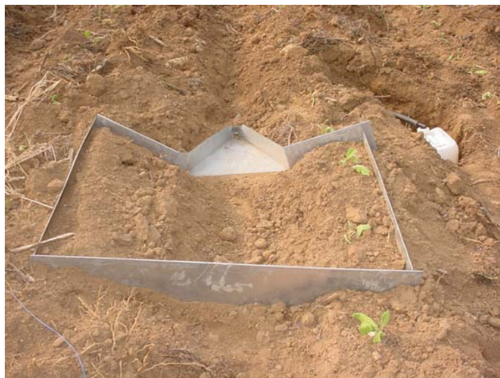
Figura 8- Sistema para coleta de enxurrada, com dimensões de 1,2 m de largura e 1 m de comprimento.
