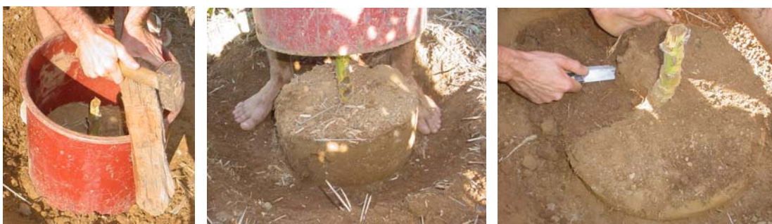
Figura 9- Coleta de raízes por volume de solo, com anel metálico de 0,45 m de diâmetro, em camadas de 0,05 m de solo.
