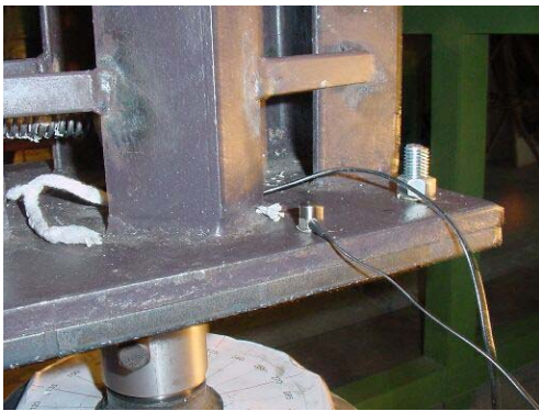
FIGURA 4.11 – Fixação do acelerômetro na base
