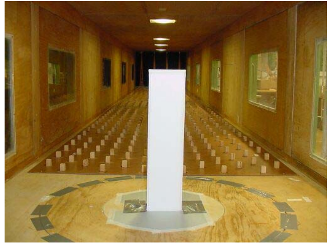
FIGURA 4.20 – Modelo ajustado no túnel, pronto para ensaio, visto de dentro
