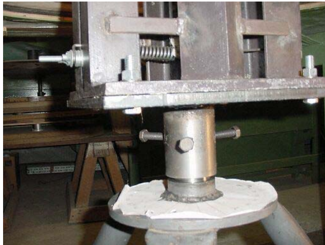
FIGURA 4.10 – Fixação entre base de transição , base rígida e base do modelo
