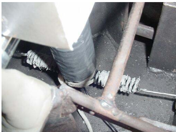
FIGURA 4.16 – Mastique aplicado sobre a mola
