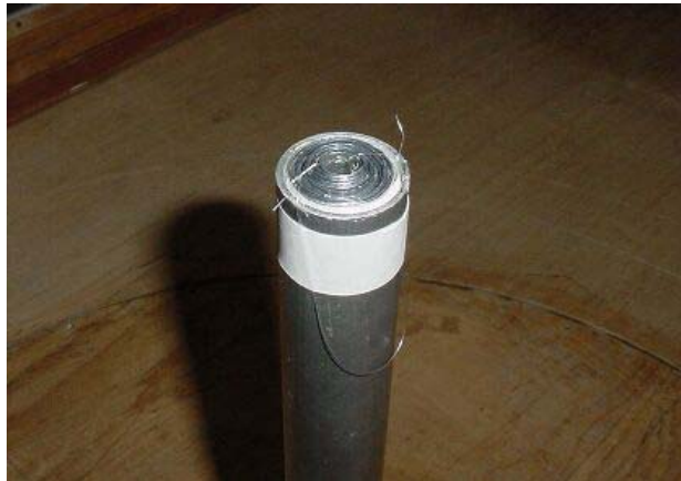
FIGURA 4.14 – Acréscimo de massa para a Configuração 2
