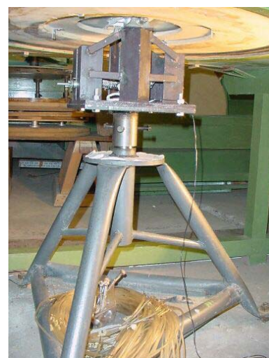
FIGURA 4.9 – Sistema mecânico fixo sobre a base rígida (tripé)
