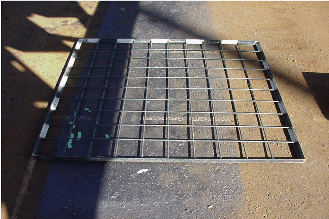
Figura 5.12: Grade metálica usada no mapeamento de trincas
