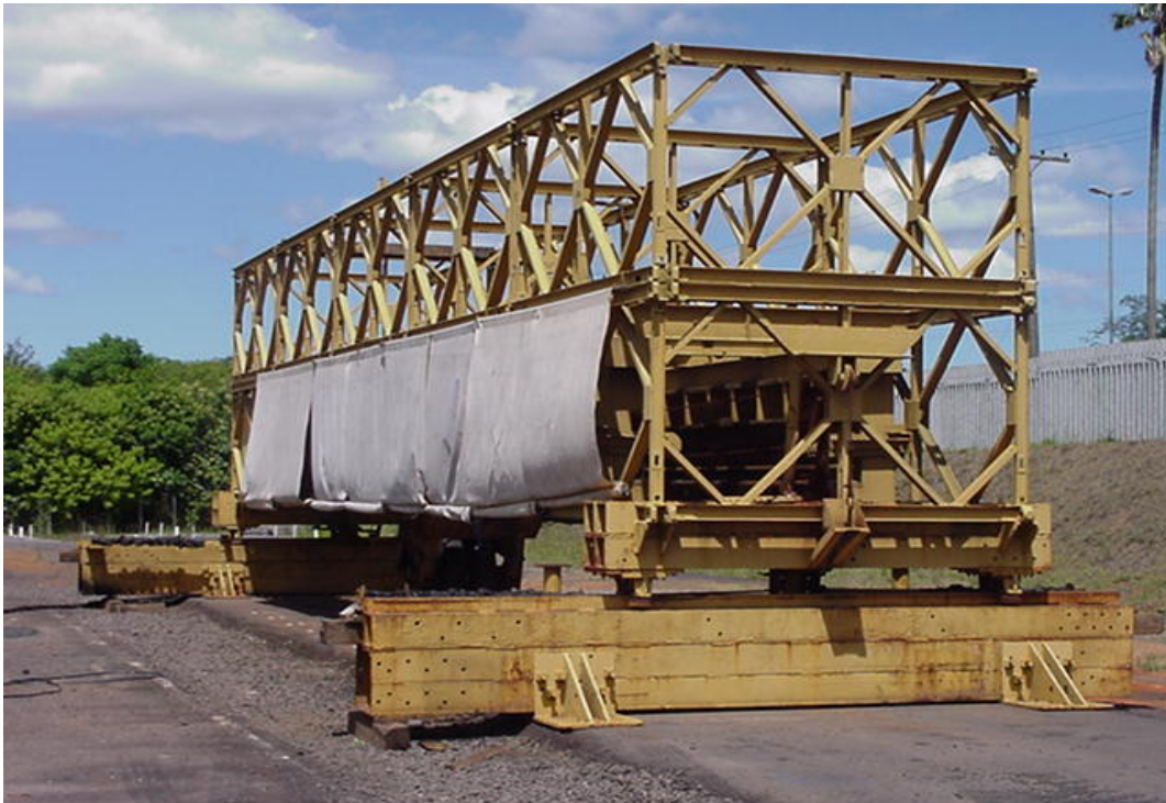
Figura 4.1: Simulador de tráfego UFRGS/DAER-RS
