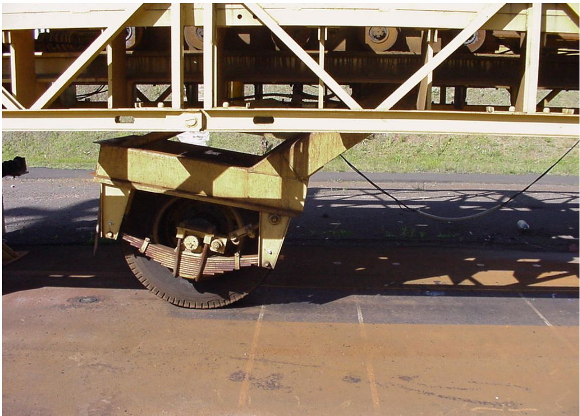
Figura 4.2: Rodado em cima do pavimento
