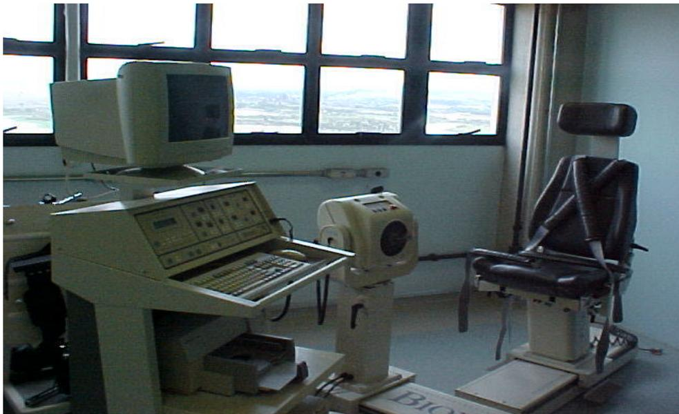
**Figura 1:** Foto do equipamento Dinamometro Isocinético Biomedex System 3
