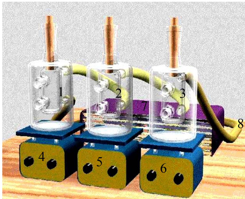
Figura 2.7. Esquema do aparato experimental: 1, 2 e 3 – células de equilíbrio; 4, 5 e 6 – agitadores magnéticos; 7 – banho termostático; 8 – mangueiras de látex (OLIVEIRA, 2004).
