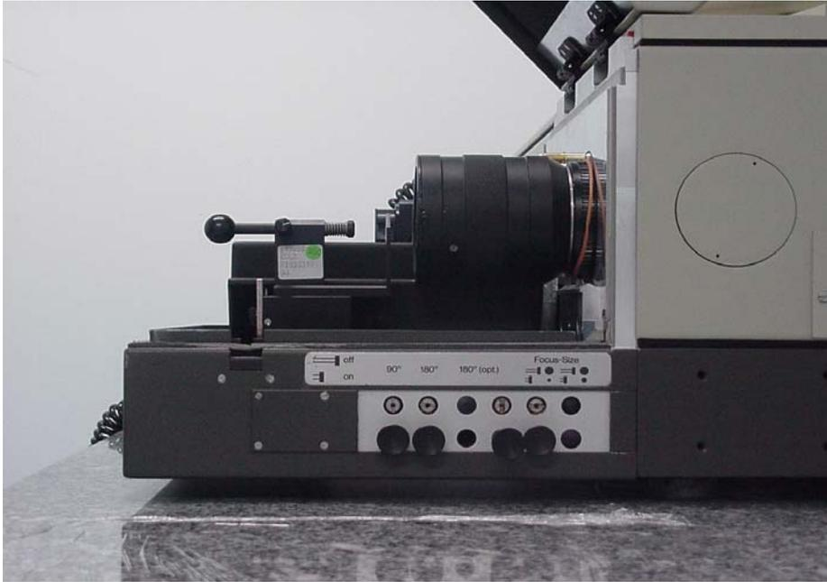
**Figura 5.** Geometria de Espalhamento e Porta Amostra do FT-Raman Spectrometer RFS 100
