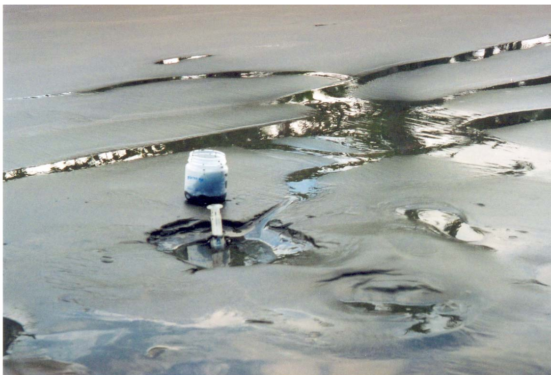
Exemplo de coleta de sedimento com amostrador cilíndrico.
