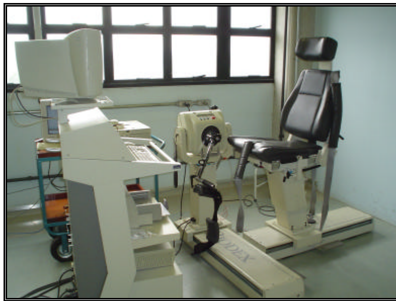
Figura 01: Dinamômetro Isocinético BIODEX e seus acessórios
