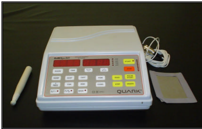
Figura 03: Gerador de pulsos NeMESys 941 – Quark e seus eletrodos, ativo e passivo
