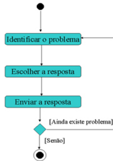
Figura 1.4 – Diagrama de Atividades de um aluno respondendo a um sistema de aprendizagem
