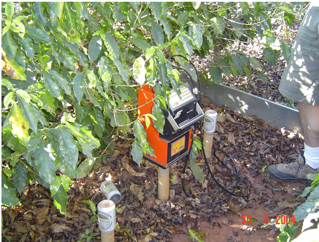
Figura 5 - Sonda de nêutrons em operação, durante uma medida de umidade do solo
