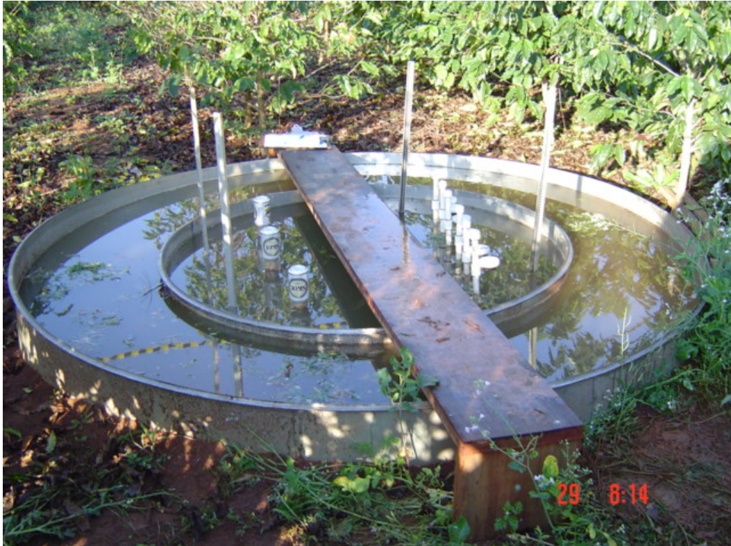
Figura 8 - Conjunto de cilindros concêntricos para uso do método de determinação da condutividade hidráulica
