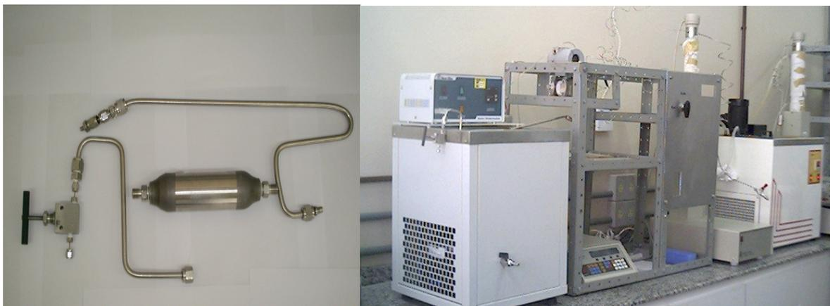
Figura 3.2. Unidade experimental para processamento em CO<sub>2</sub> pressurizado do extrato bruto enzimático de erva-mate.
