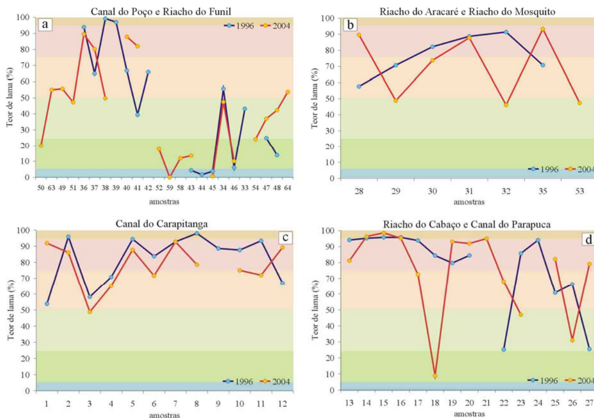
Figura 3.54. Valores de teor de lama nas campanhas de 1996 e 2004. Os gráficos estão ordenados de acordo com a distribuição geográfica dos pontos. As diferentes cores representam as faixas de classificação da granulometria, do maior para o menor teor de lama: lama, lama levemente arenosa, lama arenosa, areia lamosa, areia levemente lamosa, areia.
