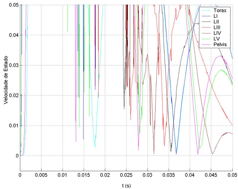
Figura 7 – Sistema com rigidez não-linear; curvas características de velocidades de estado no tempo para a direção (y) axial, sob ação de força impulsiva (250N).
