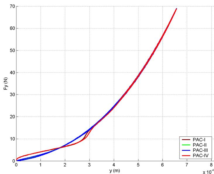
Figura 5.3 – Curvas características de forças contra deslocamentos para a vértebra LIII na direção axial (y), sujeito não-lesionado, submetido à técnica PAC: Procedimentos I, II, III e IV. Força externa ativa sobre a vértebra LIII.
