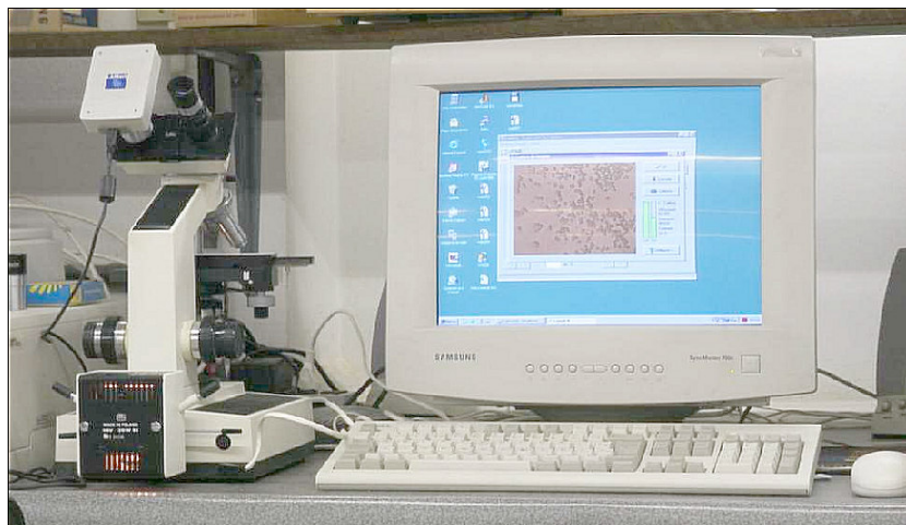
Figura 2 – Instalação do SAIMO para a aquisição. Sensor acoplado ao ocular do microscópio e conectado ao microcomputador PC através de interface USB.
